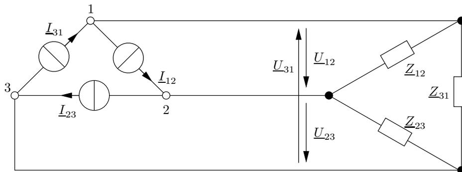
Abbildung 2: Unsymmetrische Last an symmetrischer Stromversorgung
